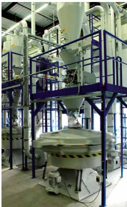
Уникальная машина ReEntry 2.0, с помощью которой старая ковровая плитка перерабатывается в сырье для новой
